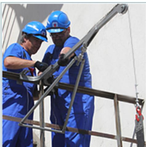
Кроме того, наружные пожарные лестницы и ограждения на крышах зданий не менее 1 раза в год должны проходить визуальную проверку целостности конструкции. В случае обнаружения нарушений целостности конструкции производиться их восстановление (ремонт) с последующей проверкой на прочность.
