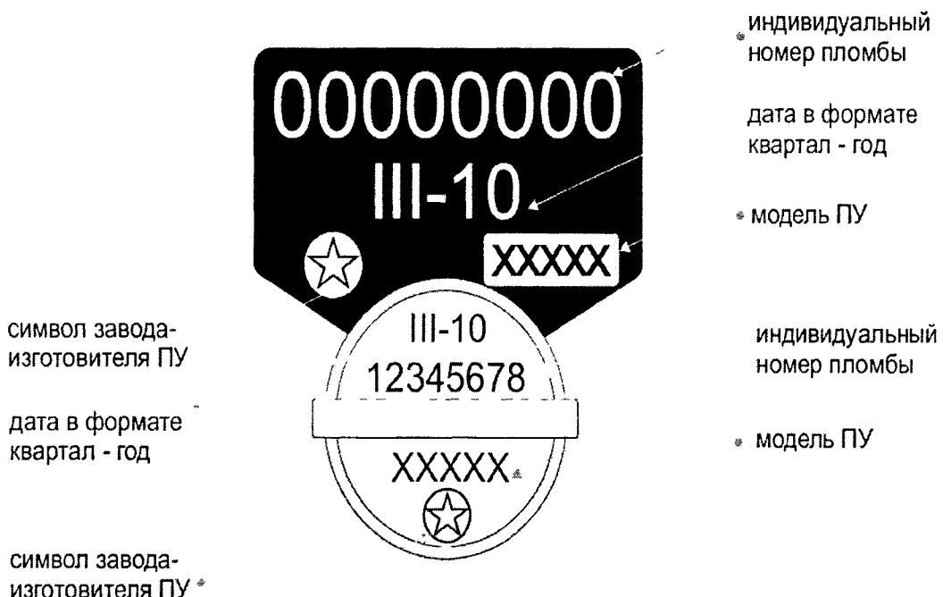
1. Контрольные пломбы с ротором белого цвета используются для опломбирования огнетушителей, произведенных заводом-изготовителем.
